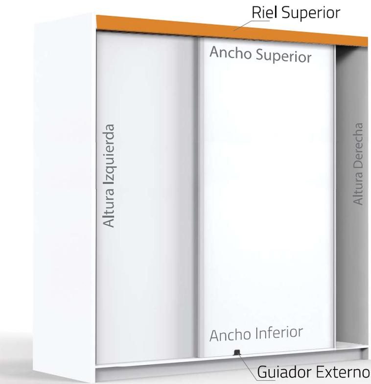
Medidas de corte para los perfiles en función de las medidas de su placard / closet.
